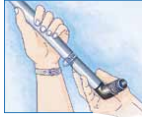
PE Boru Montajı: 1. Boru üzerinden kelepçeyi geçirin, fittingsi yerleştirin.
