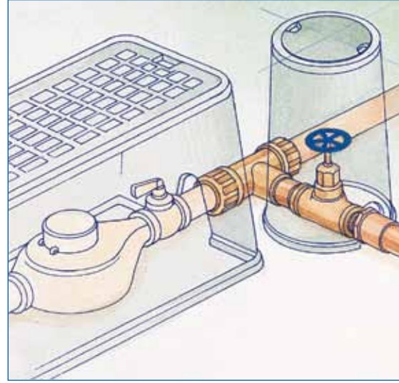
Şehir şebek suyunun B.N. ile bağlantısı: Sprinkler sisteminizi şehir şebeke hattına bağlarken pirinç döküm TE parça kullanın.
