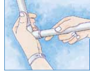
PVC: 2. Boruyu fittings içine sokun ve taşan solventi silin.
