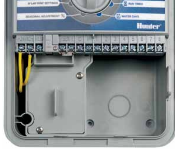
Vanaları kontrol ünitelerine bağlamak için renk kodlu sulama kabloları kullanın. Her bir vana için bir kabloya ve ek olarak ortak kabloya ihtiyacınız olacak.
