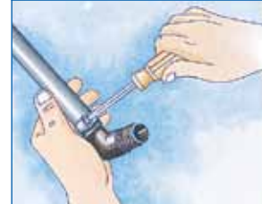
PE Boru: 2. Kelepçeyi boru etrafında sıkın.
